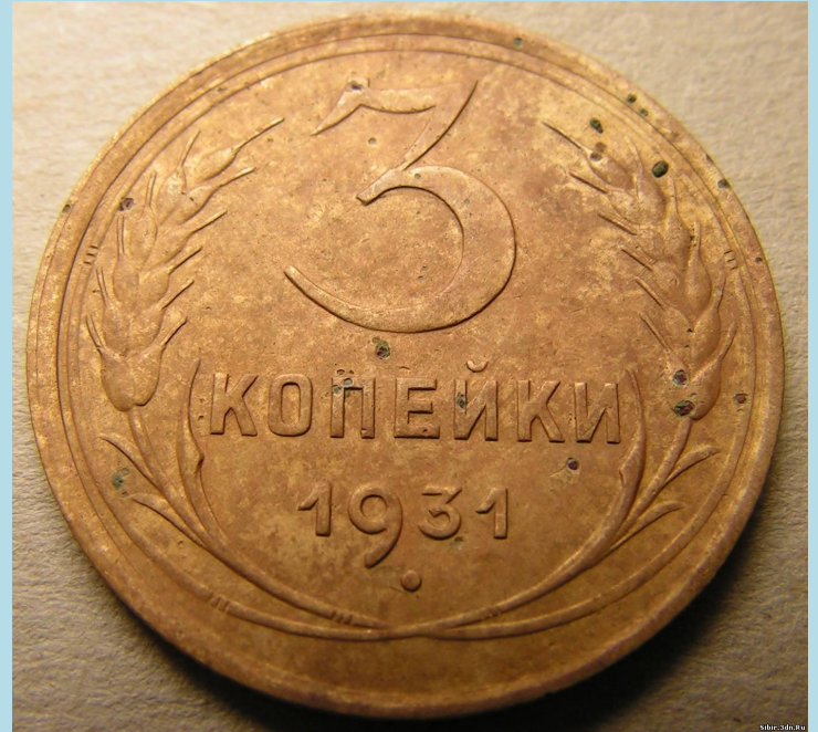
алюминиевая бронза (неоднородный сплав)
