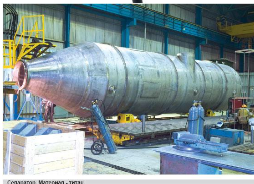
Сепаратор. Материал - титан
