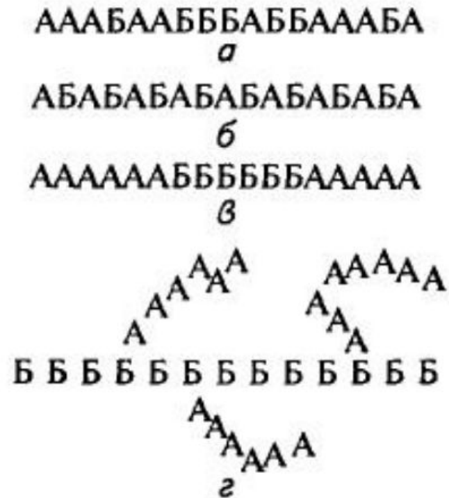
Рис. В.2. Схематическое изображение макромолекул сополимеров, состоящих из мономеров А и Б:
