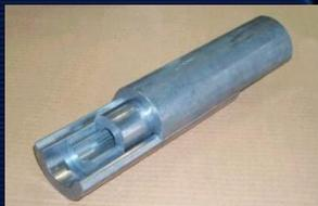
Экранированные тубы для производства радионуклидов. Эти свинцовые трубы служат для защиты магистралей транспортировки радиофармпрепаратов и нуклидов, а также для защиты линий транспортировки мишеней от циклотрона к горячим камерам.
