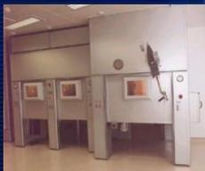
Горячие камеры для производства радиофармацевтических препаратов разработаны специально для работы с короткоживущими позитронными источниками с высокой активностью. Они используются для частично или полностью автоматизированного синтеза радиофармацевтических препаратов для позитронно-эмиссионной томографии.
