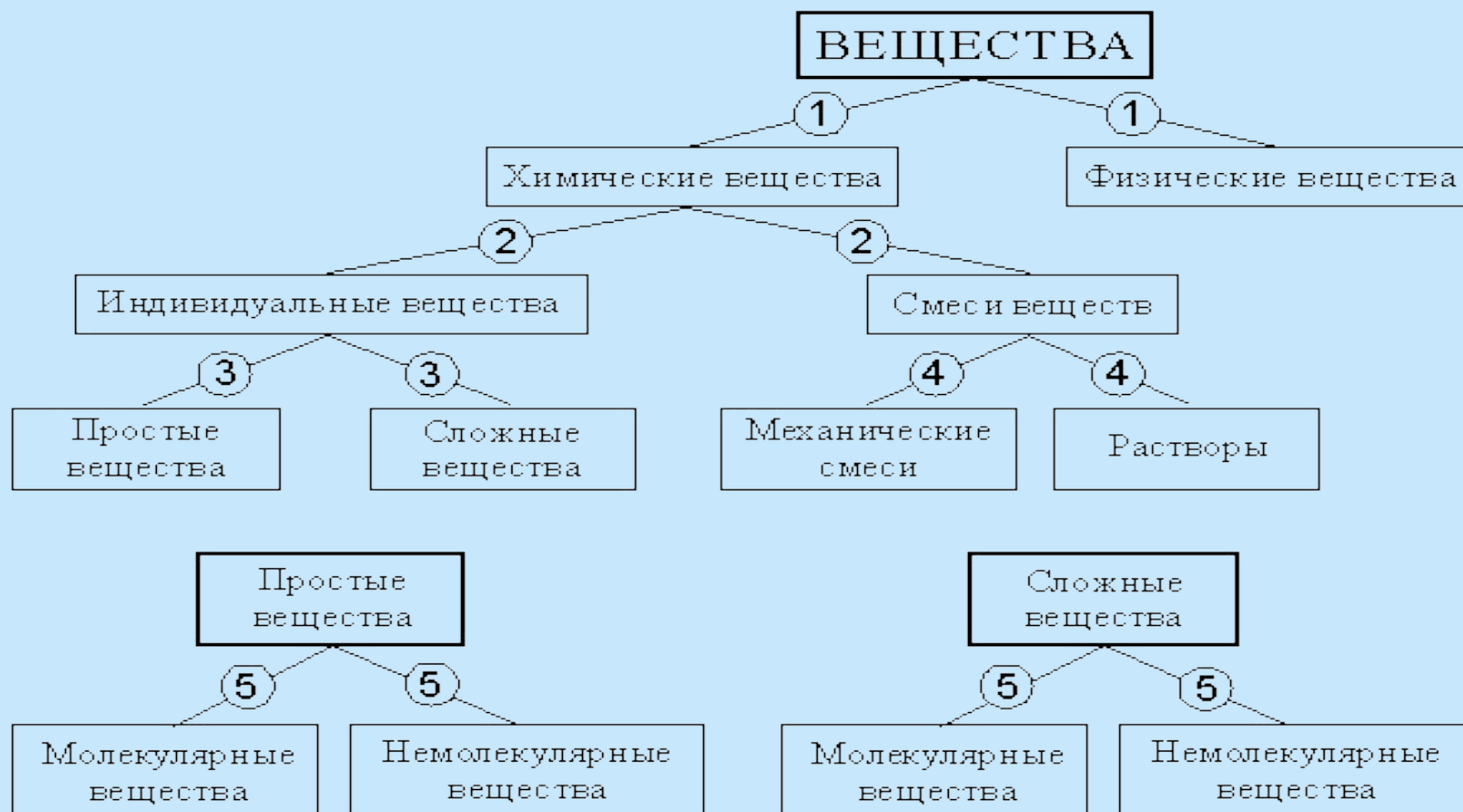
Рис. 1.3. Схема классификации веществ: по наличию ядер в образующих вещество частицах (1); по химической индивидуальности веществ (2); по содержанию атомов одного или нескольких элементов (3); по уровню, на котором перемешаны частицы (4); и по типу строения (5).
