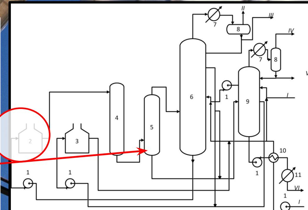
**Аппараты:** 1 – насосы; 2 – печь крекинга тяжелого сырья; 3 – печь крекинга легкого сырья; 4 – реакционная камера; 5 – эвапоратор; 6 - ректификационная колонна; 7 – конденсаторы-холодильники; 8 – рефлюксные емкости; 9 – испаритель низкого давления; 10 – теплообменники; 11 – холодильники. **Потоки:** I – горячее сырье с АВТ; II – жирный газ; III – бензин; IV – газ на факел; V – дистиллят; VI – крекинг-остаток
