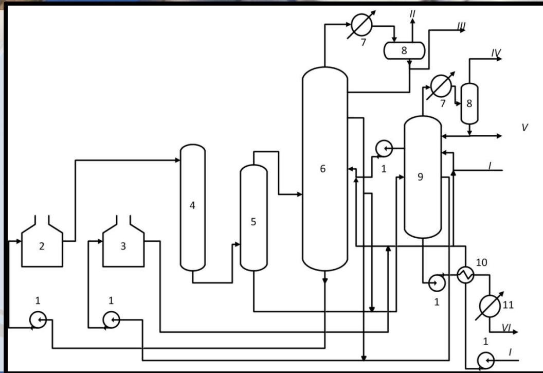
**Аппараты:** 1 – насосы; 2 – пещь крекинга тяжелого сырья; 3 – пещь крекинга легкого сырья; 4 – реакционная камера; 5 – эвапоратор; 6 - ректификационная колонна; 7 – конденсаторы-холодильники; 8 – рефлюксные емкости; 9 – испаритель низкого давления; 10 – теплообменники; 11 – холодильники. **Потоки:** I – горячее сырье с АВТ; II – жирный газ; III – бензин; IV – газ на факел; V – дистиллят; VI – крекинг-остаток
