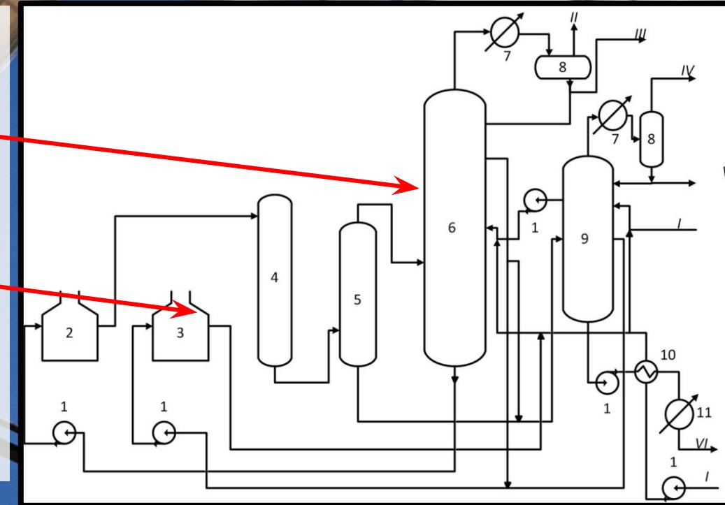
**Аппараты:** 1 – насосы; 2 – печь крекинга тяжелого сырья; 3 – печь крекинга легкого сырья; 4 – еакционная камера; 5 – эвапоратор; 6 - ректификационная колонна; 7 – конденсаторы-холодильники; 8 – рефлюксные емкости; 9 – испаритель низкого давления; 10 – теплообменники; 11 – холодильники. **Потоки:** I – горячее сырье с АВТ; II – жирный газ; III – бензин; IV – газ на факел; V – дистиллят; VI – крекинг-остаток
