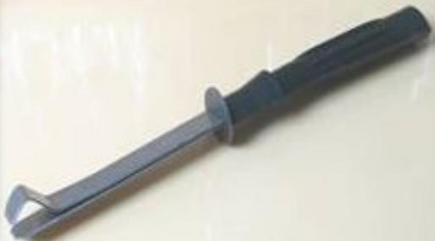
Зажим пробирочный предназначен для зажима
