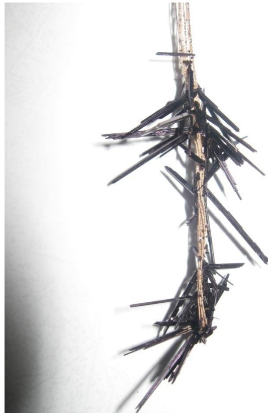
Выращивание кристаллов марганцовки путем быстрого охлаждения раствора
