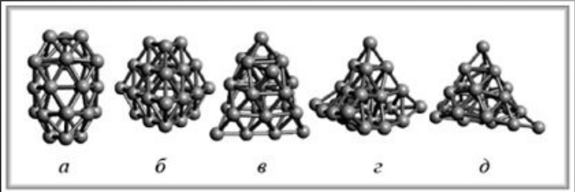
Возможные структуры нанокластера Au<sub>24</sub>. >>>
