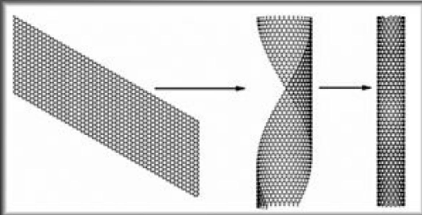
Образование одностенной трубки >>>
