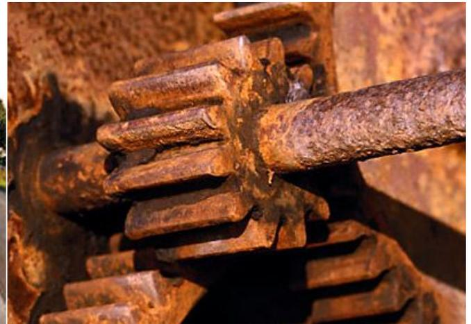
Если процесс разрушения вызван электрическим током, который образуется из-за контакта металла с электролитами называется, электрохимической коррозией.
