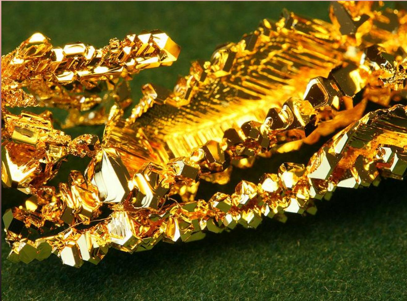
Из одного грамма золота можно вытянуть проволоку длиной 3,5 км или проковать в пластину толщиной 0,0001 мм, которая пропускает свет.
