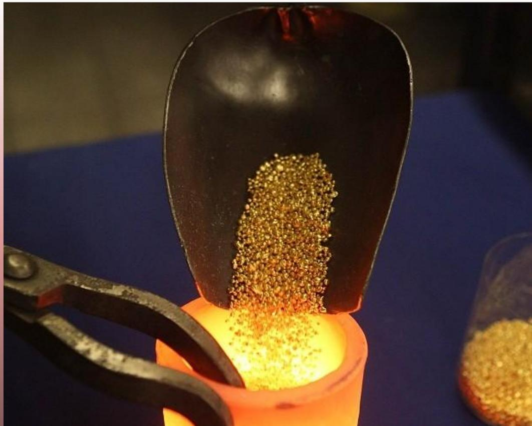
Эти сплавы хорошо режутся, шлифуются и полируются. Температура плавления чистого золота  $1063^{\circ}\text{C}$ , температура плавления сплавов – немного ниже. При отливке чистое золото имеет большую литейную усадку, для золотых сплавов усадка меньше.
