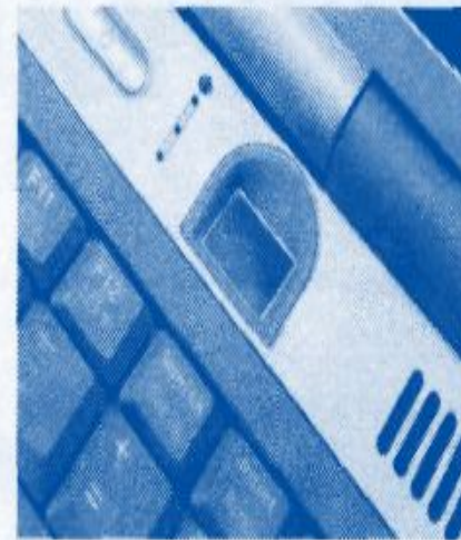
. Оптический сканер отпечатка пальца, вмонтированный в ноутбук
