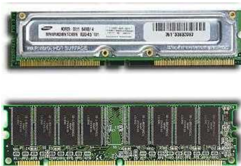
Микросхемы памяти RIMM (сверху) и DIMM (снизу)
