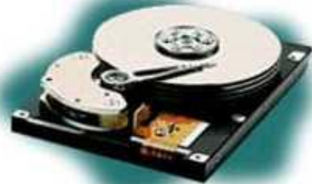
Винчестерский накопитель со снятой крышкой корпуса
