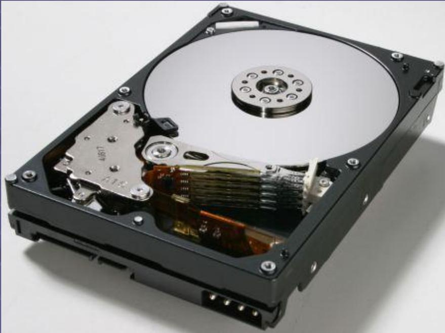
Долговременная память. При выключении компьютера вся информация из оперативной памяти стирается. Для долговременного хранения информации используется **внешняя память**. Устройство, которое обеспечивает запись и считывание информации, называется **накопителем или дисководом**, а хранится информация на **носителях информации**. Информация на носителях хранится в цифровой форме, то есть в форме последовательностей нулей и единиц.
