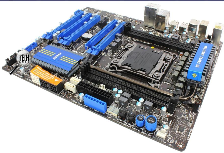
**Материнская плата** – это сложная многослойная печатная плата к которой подключаются остальные компоненты компьютера. Материнская плата покрыта сетью медных проводников-дорожек по ним электропитание и данные поступают к смонтированным на плате микросхемам и слотам, в которые вставляются остальные устройства компьютера.
