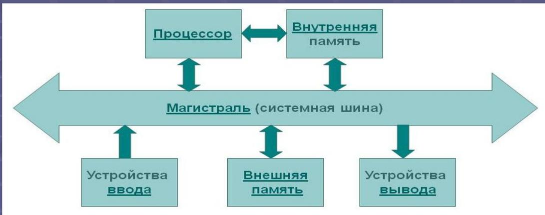
**Системная шина** — в архитектуре компьютера подсистема, которая передаёт данные между функциональными блоками компьютера. В связи с этим разделяется механический, электрический (физический) и логический (управляющий) уровни.
