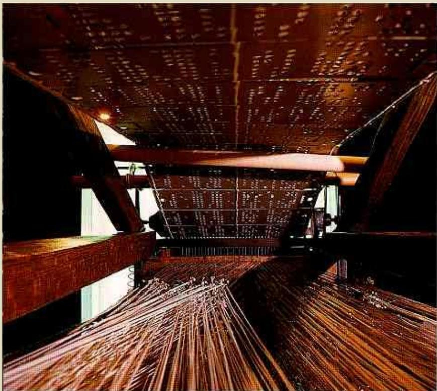
В 1801 году Жозеф Мари Жаккар разработал ткацкий станок, в котором вышиваемый узор определялся перфокартами. Серия карт могла быть заменена, и смена узора не требовала изменений в механике станка.
