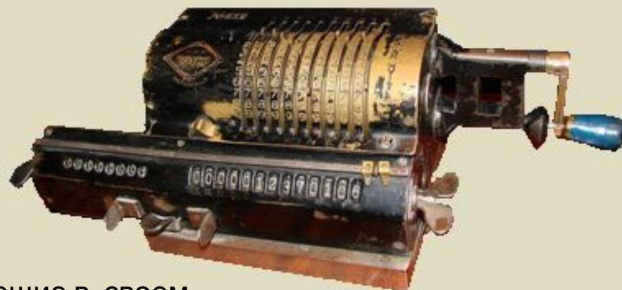
Арифмометры, использующие в своем устройстве принцип зубчатого колеса просуществовали до 60-х годов 20 века.
