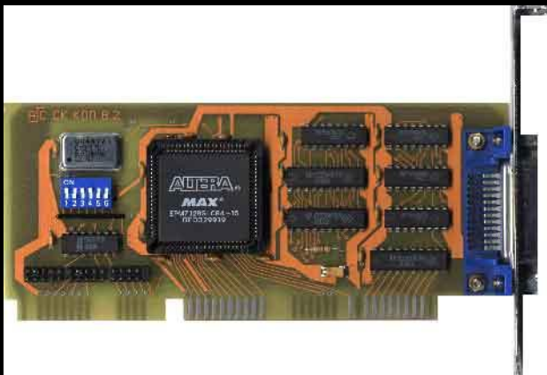
Аппаратные средства конфигурирования: а — джампер; б — DIP-переключатель
