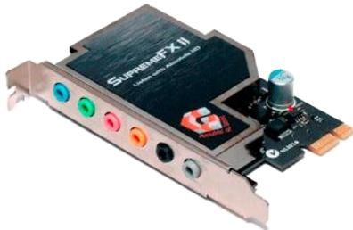
**звуковая карта.** Является устройством вывода звукового сигнала на периферийные устройства вывода, акустические системы, наушники и так далее.
