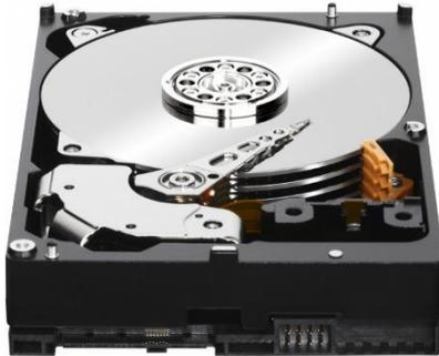
(Винчестер, HDD, harddisk) - это устройство хранения информации на Вашем компьютере. При выключении питания данные не стираются. По сравнению с оперативной памятью скорость работы HDD намного ниже, а объем хранимой информации намного больше.
