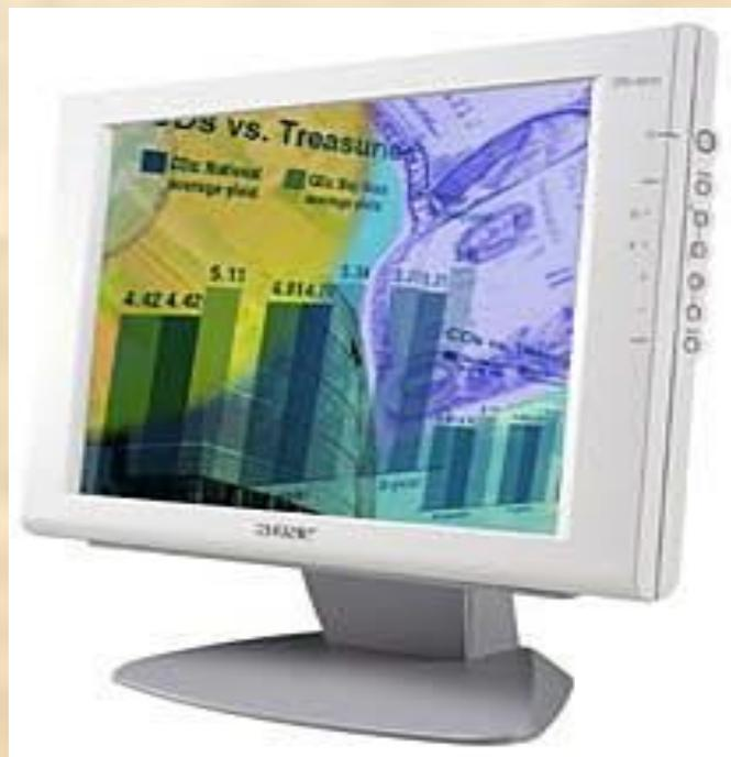
В LCD-мониторах изображение формируется с помощью матрицы пикселей, состоящих из жидких кристаллов. Отсюда и происходит аббревиатура LCD, которая расшифровывается как жидкокристаллический дисплей.
