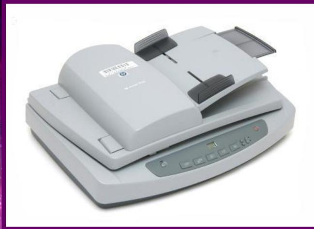
Сканируемый лист протягивается по принципу факса. Протяжные сканеры по своим возможностям, размерам находятся между ручными и планшетными сканерами. Они отличаются хорошим качеством сканирования и удобством работы от ручных сканеров и значительно меньше планшетных. Недостаток заключается в том, что он не способен работать с толстыми оригиналами.
