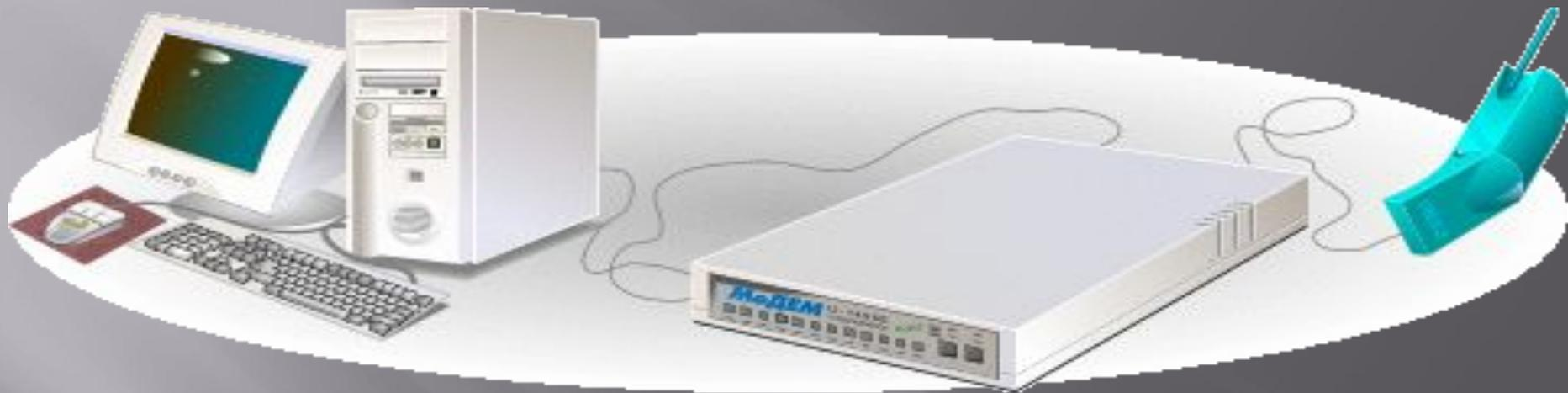
**Для соединения компьютеров используют обычные телефонные линии и прибор модем.**
