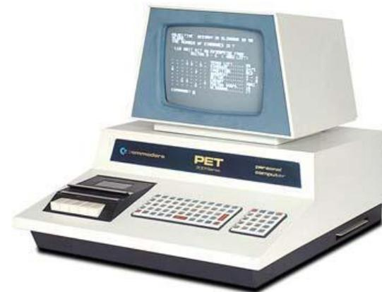
**PET** (Personal Electronic Transactor) фирмы Commodore принадлежал к немногочисленным компьютерам, объединившим в одном модуле системный блок, монитор, накопителя и клавиатуру. PET содержал процессор 6502, 14 Кбайт ПЗУ с Basic и операционной системой, 4 Кбайт ОЗУ, 9-дюймовый монитор и кассетный магнитофон. Этот компьютер считался идеальным решением для преподавателей и учащихся при цене 595\$.
