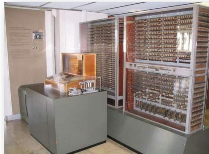
Следующая машина Цузе — Z3, была завершена в 1941 году. Она была построена на телефонных реле и работала вполне удовлетворительно. Тем самым, Z3 стала первым работающим компьютером, управляемым программой.
