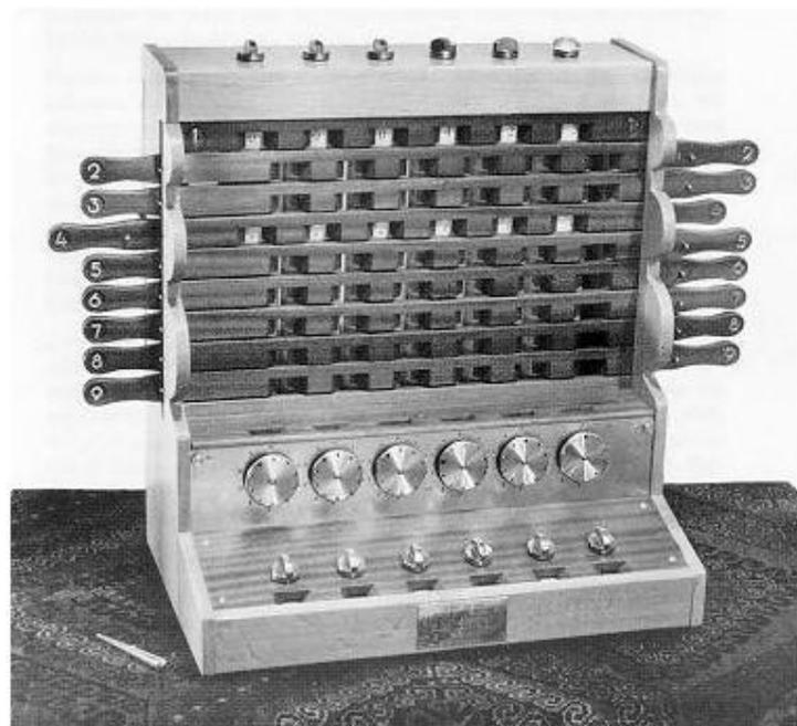
Это был первый механический калькулятор, умевший выполнять четыре арифметических действия. Это устройство также называли «считающими часами» потому, что как и в настоящих часах работа механизма была основана на использовании звёздочек и шестерёнок.
