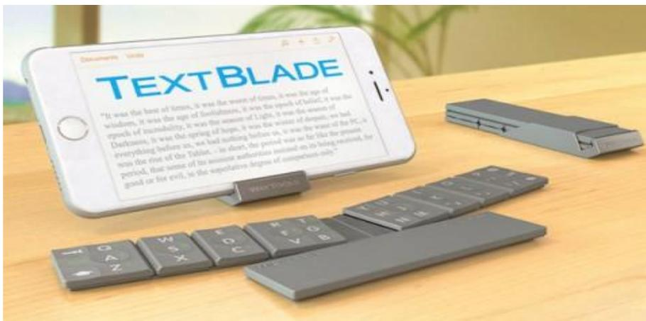
Компания WayTools создала Bluetooth клавиатуру TextBlade - маленькую по размеру, но очень функциональную. Эта складная клавиатура распадается на три части для удобства хранения, но все они соединяются вместе при помощи магнитов для тактильного набора. В продажу поступила весной 2015 года.
