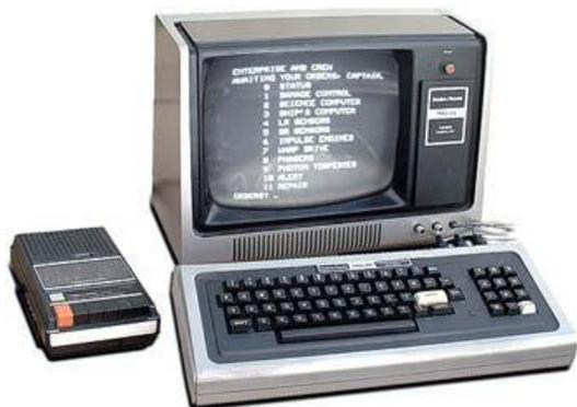
**TRS-80**, с процессором Z-80, состоял из четырех модулей - 12-дюймового монитора, системного блока с интегрированной клавиатурой, блока питания и кассетного магнитофона Radio Shack CTR-41. Компьютер поставлялся с зашитым в ПЗУ Basic Level и двумя кассетами, одна из которых содержала игровые программы
