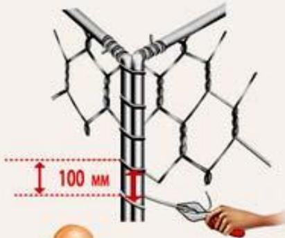
4. Поднимите и закрепите внутреннюю диафрагму к передней и задней стенкам
