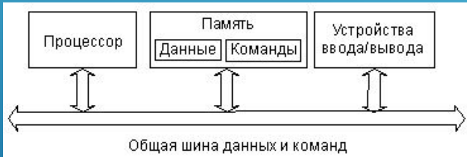
Рис. 1.4. Архитектура с общей шиной данных и команд.
