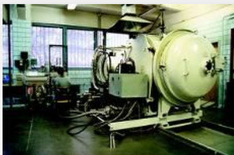
вакуумная камера в Институте космических исследований
