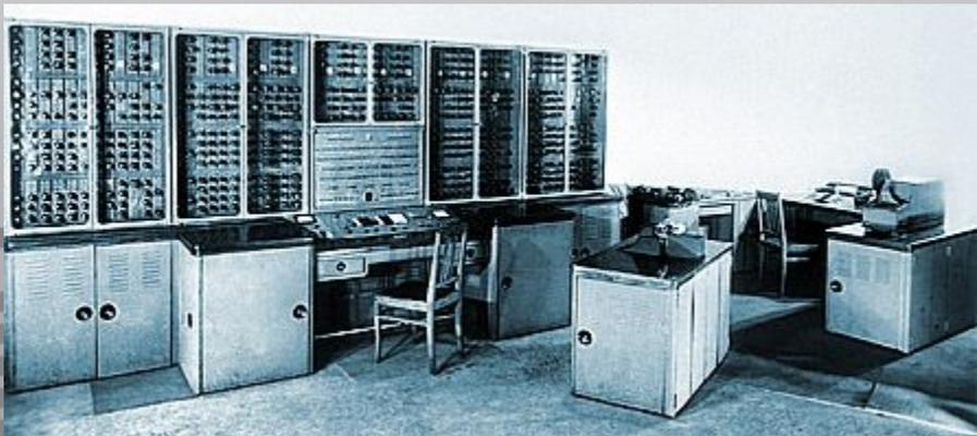
Первым создателем автоматической вычислительной машины считается немецкий учёный **Конрад Цузе**. Работы им начаты в 1933 году, а через три года им построена модель механической вычислительной машины, в которой использовалась двоичная система счисления, перфокарты и программирование. В качестве элементной базы Цузе выбирает *реле*, которые к тому времени давно применялись в различных областях техники.
