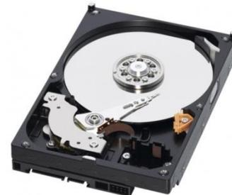
***Жесткий диск — устройство хранения информации произвольного доступа, основанное на принципе магнитной записи.***
