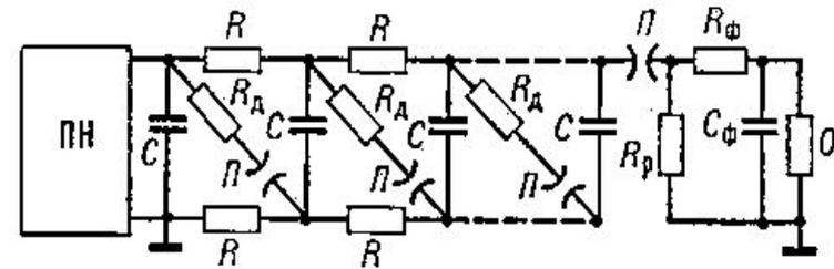
СТРУКТУРНАЯ СХЕМА ИМПУЛЬСНОГО ИСТОЧНИКА ПИТАНИЯ
