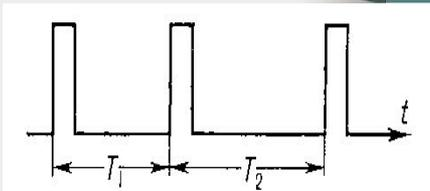
Рис. 1. Импульсный сигнал из трёх прямоугольных импульсов
