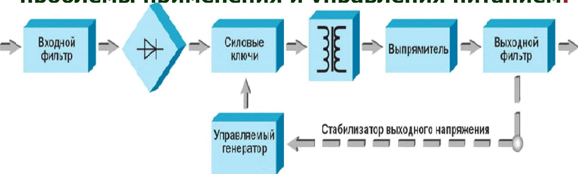
**Импульсные ИП используют методы и физические явления для генерации стабилизированного напряжения, а именно: эффект накопления энергии в катушках индуктивности, а также возможность высокочастотной трансформации и преобразования накопленной энергии в постоянное напряжение**
