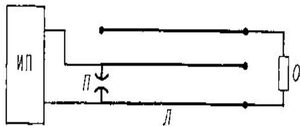
Схема генератора Блумлейна: ИП — источник постоянного напряжения или ГИН; Л — трёхполосная полосковая линия.
