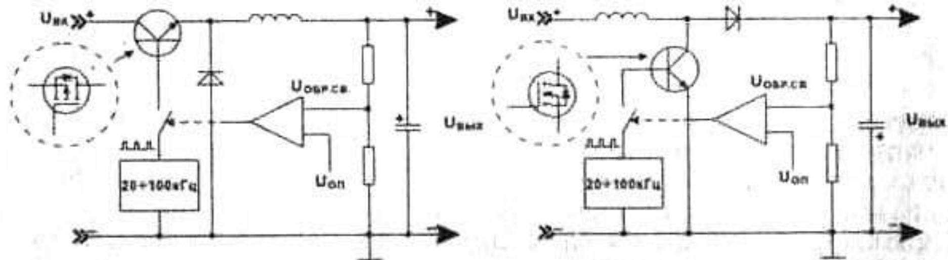
а) Понижающий импульсный ИП ( $U_{\text{вых}} < U_{\text{вх}}$ )
