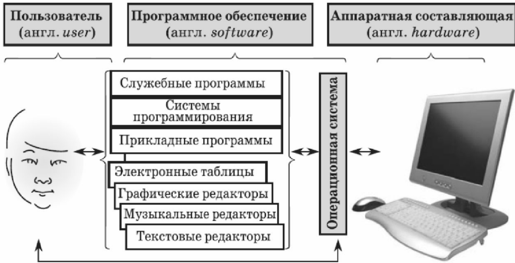
Схема работы пользователя с программным обеспечением и аппаратной составляющей компьютера
