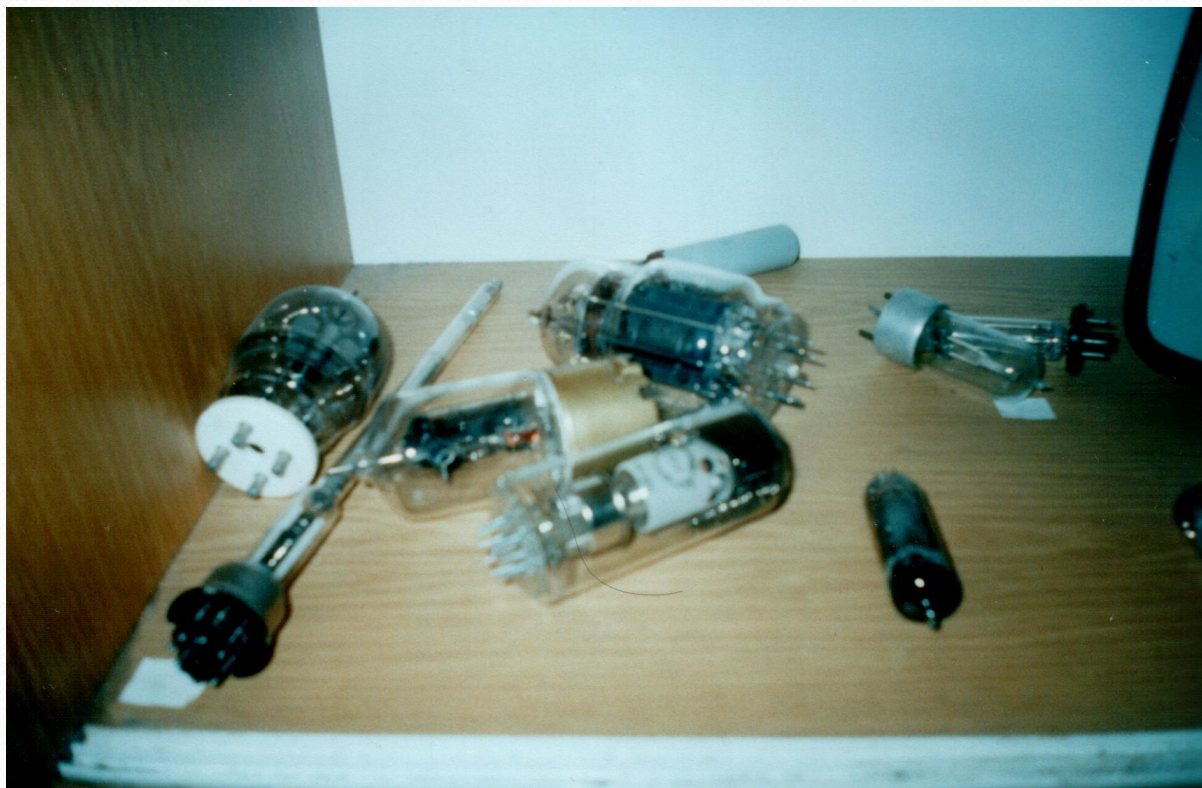
Электронные лампы 40-х годов — элементная база компьютеров 1-го поколения
