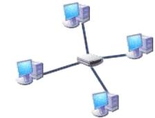
Звезда — базовая топология компьютерной сети, в которой все компьютеры сети присоединены к центральному узлу (обычно сетевой концентратор).
