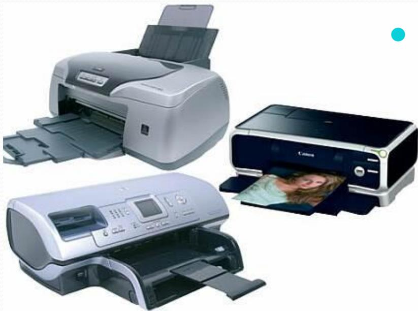
Ряд струйных принтеров могут работать с рулонной бумагой. Почти все современные струйные принтеры печатают не только черными чернилами, но и позволяют использовать многоцветную печать. Для цветной печати в принтер устанавливается дополнительная печатающая головка (или картридж).
