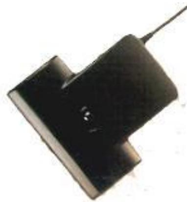
Сканеры разделяют на ручные и планшетные. Ручные сканеры – это относительно недорогие устройства небольшого размера, удобны для оперативного сканирования изображений из книг, журналов. Ширина полосы сканирования обычно не превышает 105 мм, стандартное разрешение 600 dpi. К недостаткам ручного сканера можно отнести зависимость качества сканирования от навыков пользователя и невозможность одновременного сканирования относительно больших изображений.
