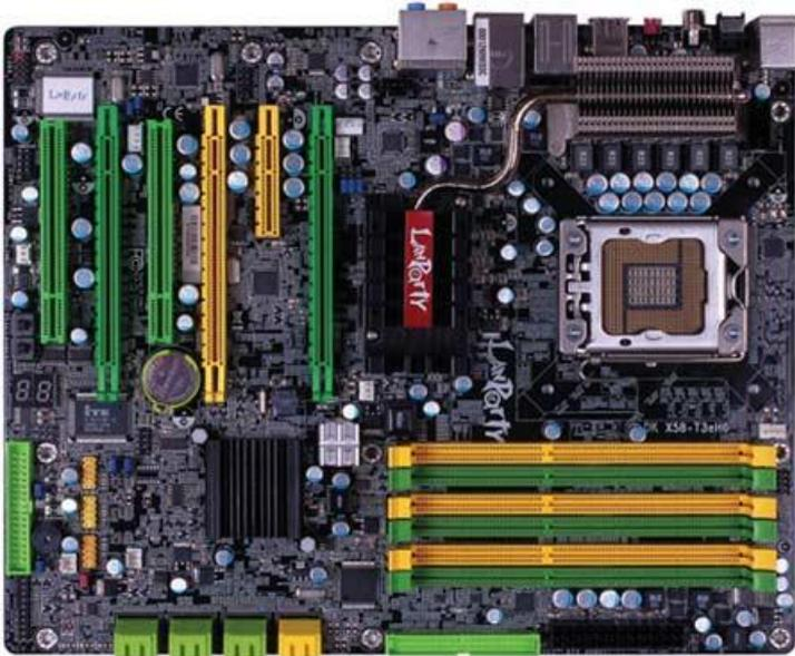
Системная плата является основным аппаратным устройством компьютера. На системной плате реализована **магистраль** обмена информацией, имеются разъемы для установки процессора и модулей оперативной памяти, а также разъемы для подключения внешних устройств (принтеров, сканеров, модемов и др.).
