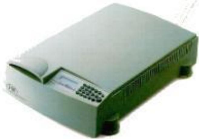
Планшетные сканеры осуществляют сканирование в автоматическом режиме. Оригинал располагается в сканере на стеклянном листе, под которым головка чтения с CCD-элементами сканирует изображение построчно с равномерной скоростью. Размеры сканируемых изображений зависят от размера сканера и могут достигать размеров большого чертежного листа (A0). Специальная слайд-приставка позволяет сканировать слайды и негативные пленки. Аппаратное разрешение планшетных сканеров достигает 1200 dpi.
