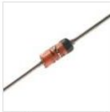
Стабилитроны 0,5W Стабилитроны 0,5W
