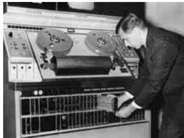
Один из первых видеоманитонов RCA с линейной записью
