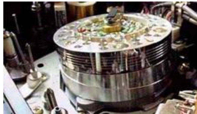
Блок вращающихся головок - сердце видеоманитона VHS
