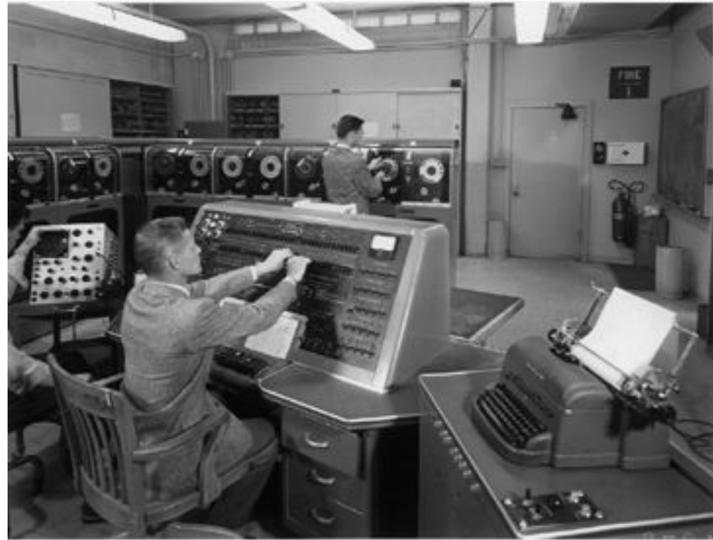
Пульт управления машины UNIVAC 1951 г
