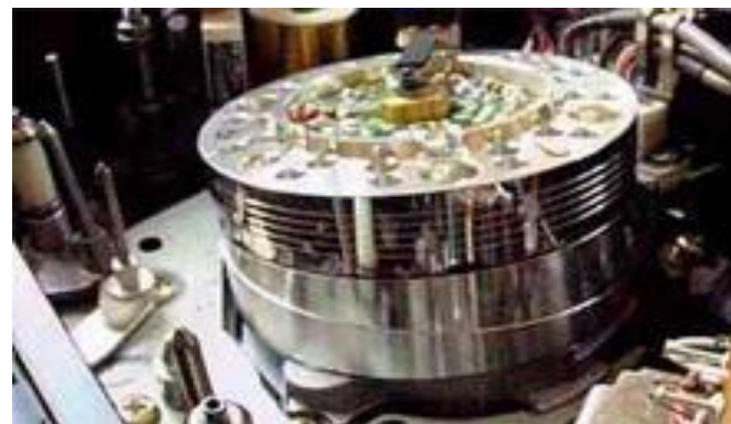
Блок вращающихся головок - сердце видеоманитона VHS
