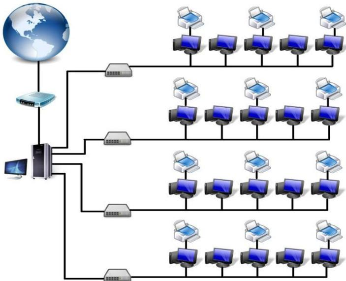
**Глобальный IP адрес** – это адрес компьютера (или его маршрутизатора) в пределах более высокоуровневой сети, например сети Интернет.
