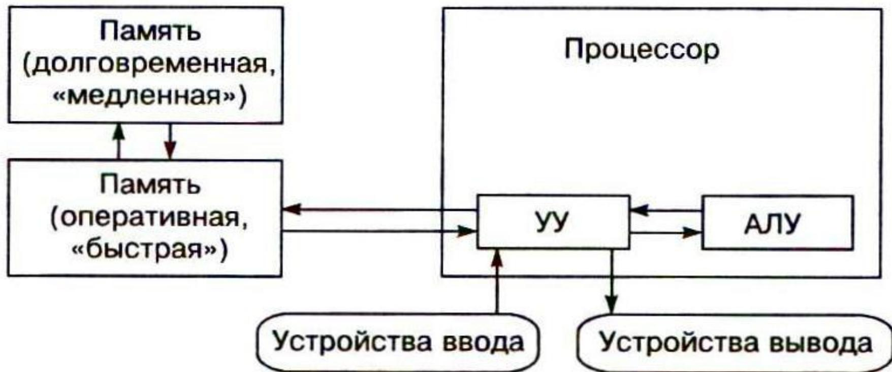
Схема взаимодействий устройств компьютера согласно архитектуре фон Неймана
