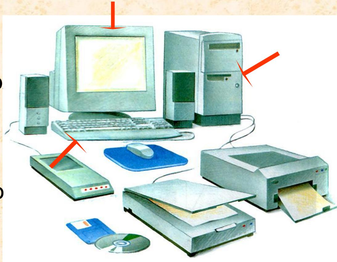
Системный блок и монитор независимо друг от друга подключаются к источнику питания – сети переменного тока (как правило, **напряжением 220 В**, но возможны и другие напряжения).
