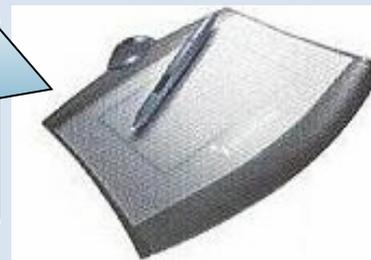
Электронная ручка Activpen функционирующая без проводова и без батарейки. Электронная ручка пишет точно так же, как и обычная ручка. В то же время ручка выполняет функцию компьютерной мыши.
