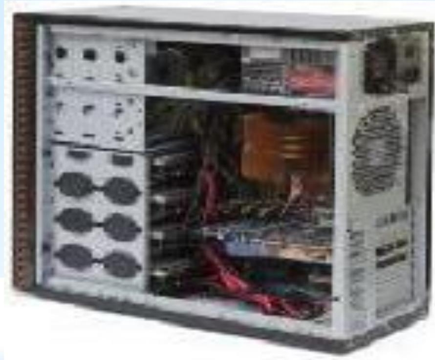
Здесь расположены все перечисленные части компьютера. Бывают различных размеров и форм-факторов. Чем корпус объемней и массивней, тем легче обеспечивать хорошее охлаждение и низкий уровень шума.
