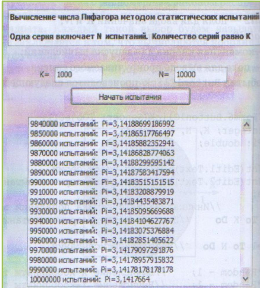
Чтобы можно было проследить за установлением значения числа  $\pi$ , испытания разбивают на серии. В одной серии производится N испытаний, а число таких серий равно K. После завершения каждой серии на экран выводится результат.
