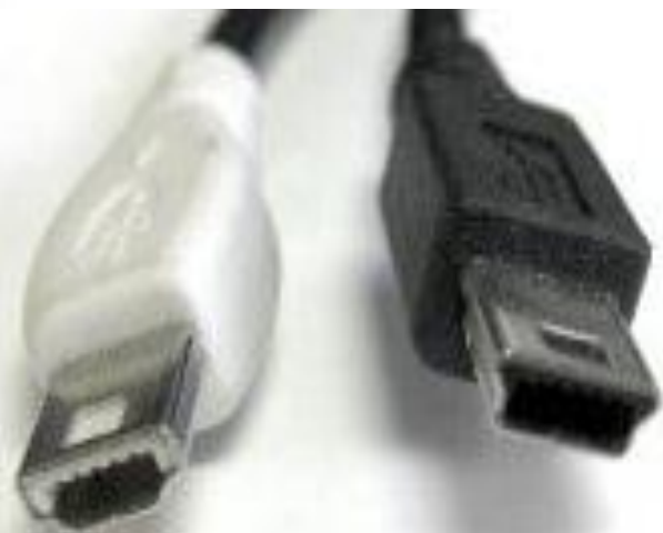
Mini USB Тип А (слева) и Mini USB Тип В (справа)
