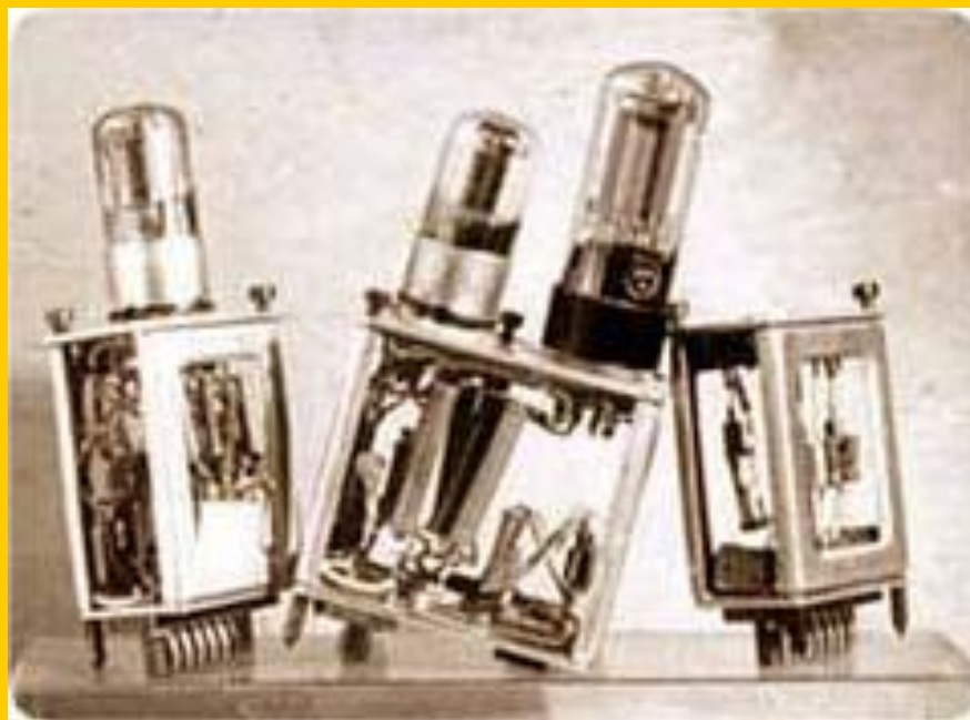
Ламповый элемент СЭСМ (Специализированной Электронной Счетной Машины)
