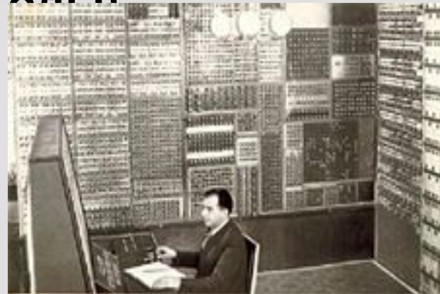
1950 год. МЭСМ (малая электронно-счетная машина)
