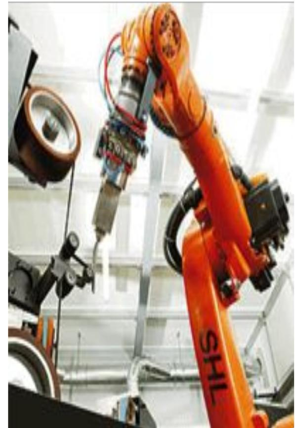
Манипуляционный робот, т. е. автоматическое устройство, состоящее из манипулятора и перепрограммируемого устройства управления, которое формирует управляющие воздействия, задающие требуемые движения исполнительных органов манипулятора. Применяется для перемещения предметов производства и выполнения различных технологических операций.
