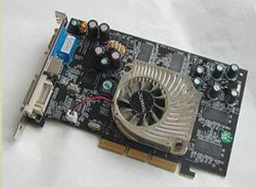
*Видеокарта* – это устройство, получающее от процессора видеоданные, обрабатывающее их и передающее монитору, в результате чего создается изображение.
