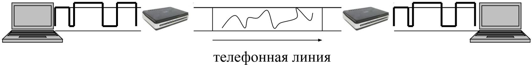
Аналоговый *модем* обеспечивает *модуляцию* и *демодуляцию* сигнала при его передаче по телефонным линиям
