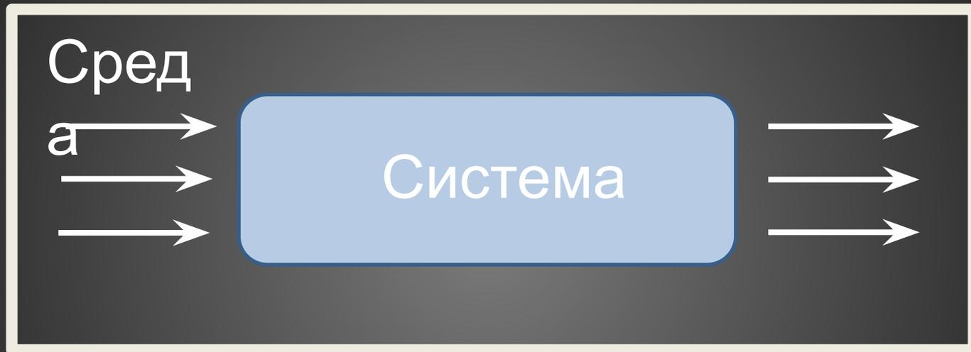
Воздействие среды на систему называют **входами системы**, а воздействие системы на среду – **выходами системы**.
