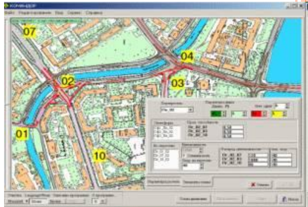
Имитационная модель дорожного движения, позволяющая прогнозировать изменение ситуации на дорогах в выбранном масштабе времени
