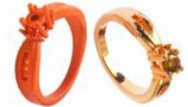
С помощью 3D принтера можно создать идеальную пресс-форму для отливки настоящих изделий.
