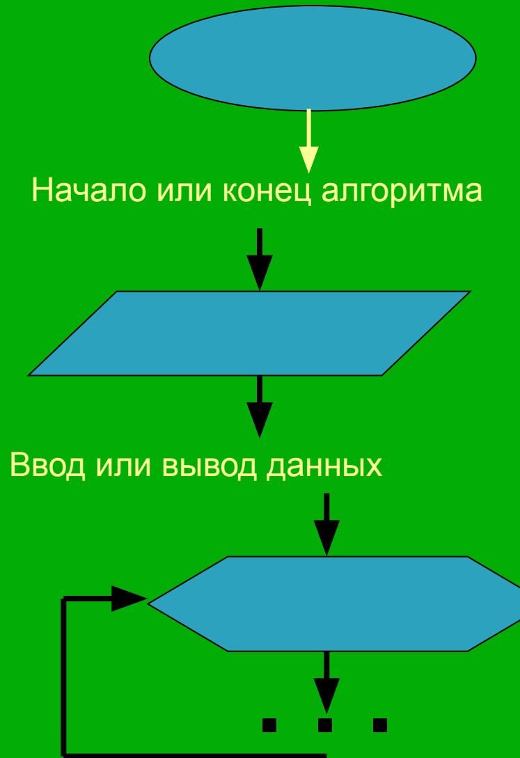
Для более наглядного представления алгоритма широко используется графическая форма – блок-схема, которая составляется из стандартных графических объектов.
